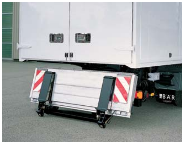
Pakiet złożonej platformy otwierany jest podczas funkcji opuszczania windy.
