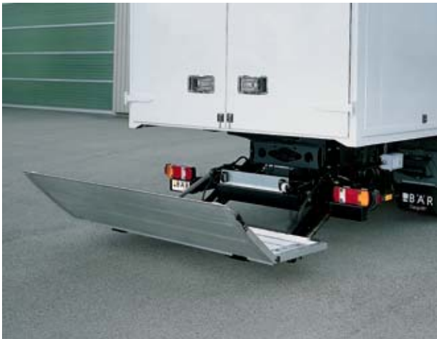
Ręczne otwieranie platformy (wspomagane sprężyną).
